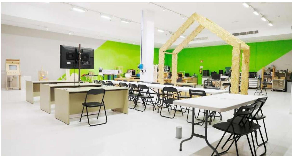
El laboratorio de fabricación digital es un amplio espacio de taller dividido en varias zonas de trabajo equipadas con las herramientas y la maquinaria necesarias para desarrollar proyectos *maker* y de fabricación digital: zona de corte láser, zona de carpintería y fresado por control numérico (CNC), zona de impresión 3D y zona de electrónica. Cuenta además con un espacio equipado para el trabajo con grupos escolares.
